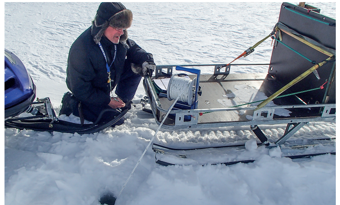
Paksuvuonon syvänehavaintopaikalta mitataan koko vesipatsaan lämpötila pohjaan eli 42 metrin syvyyteen asti. Veden lämpötilat sekä talvikautena myös jään paksuudet käydään mittaamassa 10 päivän välein. Havainnoitsija Heimo Pukkila mittaustyössään talvikaudella.
